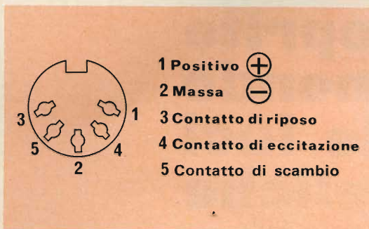
Fig. 9 - Collegamenti della presa a 5 poli.
